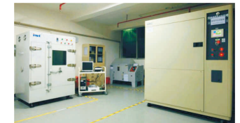
자연 대류 테스트기(좌) 열 충격 테스트기(우)
